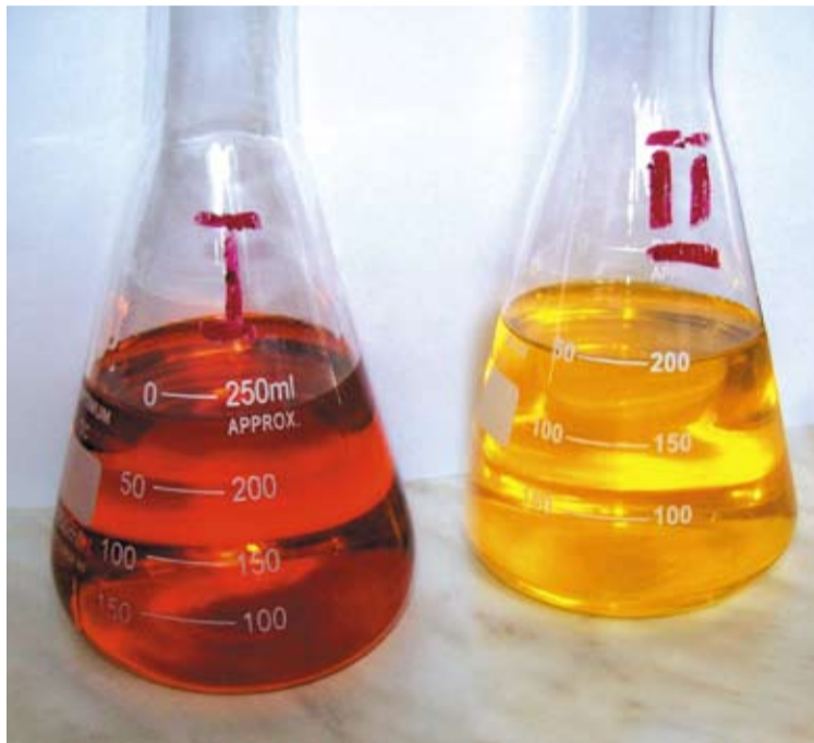
Трансформаторное масло до (слева) и после очистки по технологии «Флюидэкс».
